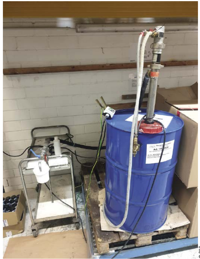
Abb. 3: Die Pumpen lassen sich sehr leicht zerlegen, da keine Dichtungen beim Ausbau das Ziehen von Exzentrerschnecke oder Antriebswelle behindern.
