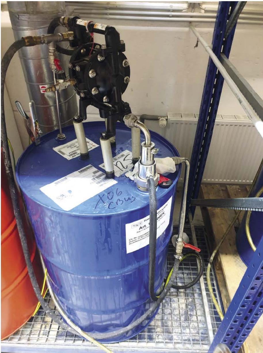
Abb. 1: Das leicht dickflüssige Trennwachs fördert eine Druckluft-Membranpumpe zuverlässig.
