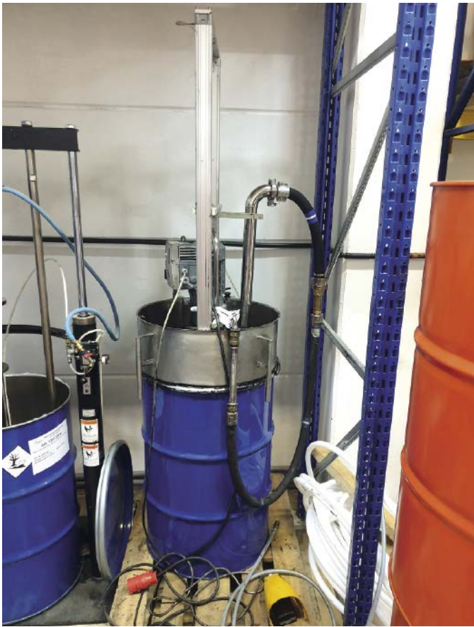
Abb. 2: Für offene 200 l Fässer mit nicht mehr fließfähigen Medien gibt es das mobile Fassentleerungssystem Viscoflux. Dieses fördert per Exzenterpumpe zähflüssige bis pastöse Medien.
