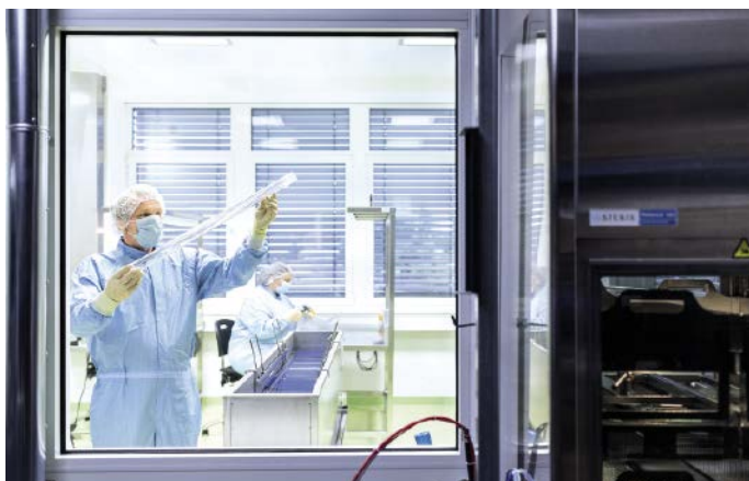
Abb. 2: Bearbeitete Teile gelangen durch eine Reinigungsschleuse (rechts) in den Reinraum, wo sie montiert und verpackt werden. Große Teile wie die hier gezeigte Komponente für einen Bioreaktor werden in einem Ultraschallbecken mit hochreinem Osmose-Wasser gereinigt.
