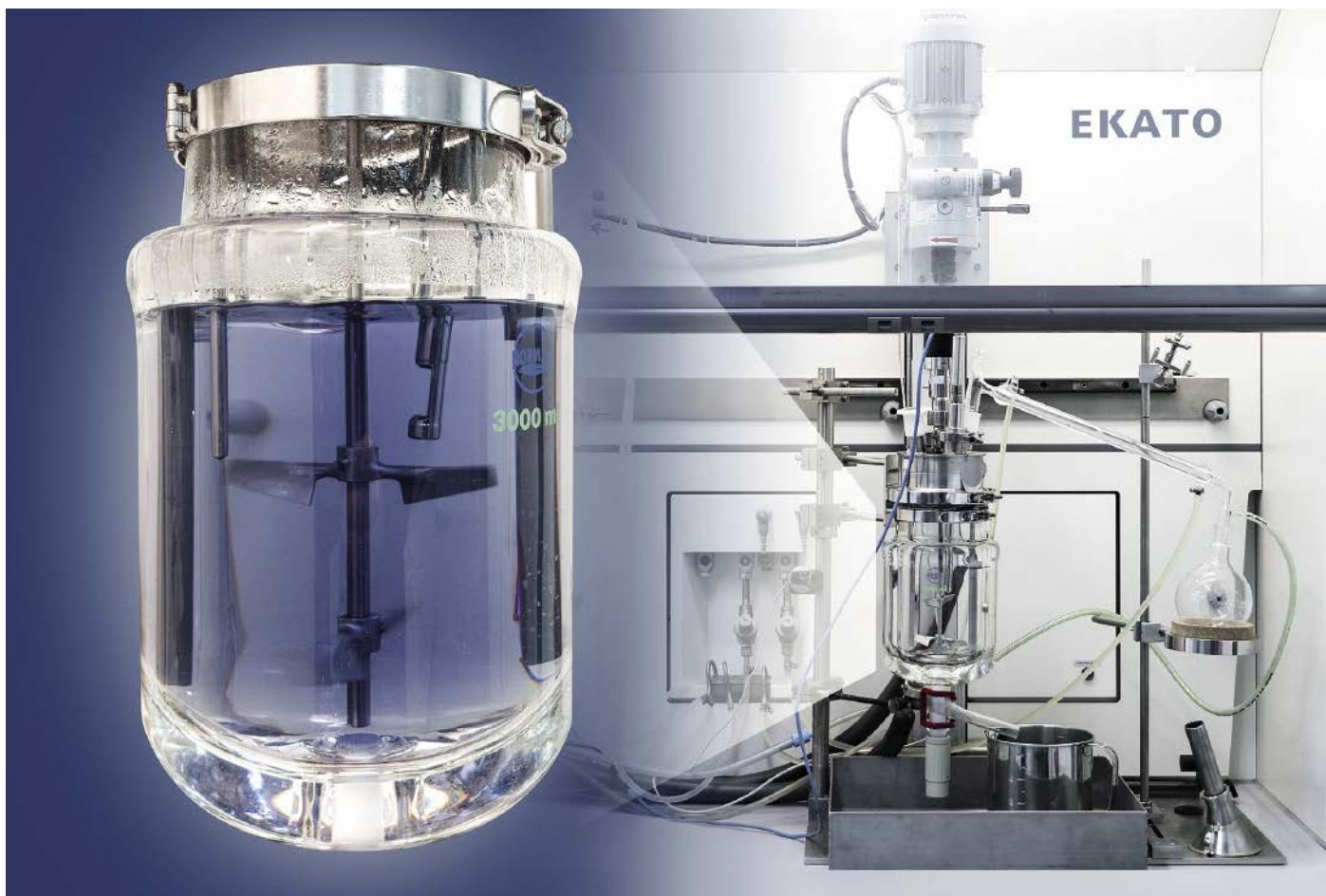
Abb. 2: 3-I-Kristallisationsapparat im Labor
