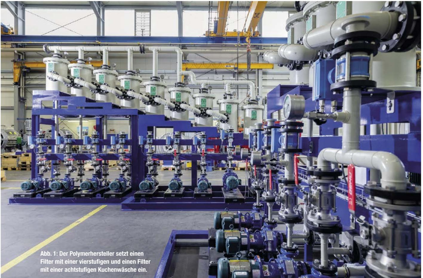
Abb. 1: Der Polymerhersteller setzt einen Filter mit einer vierstufigen und einen Filter mit einer achtstufigen Kuchenwäsche ein.
