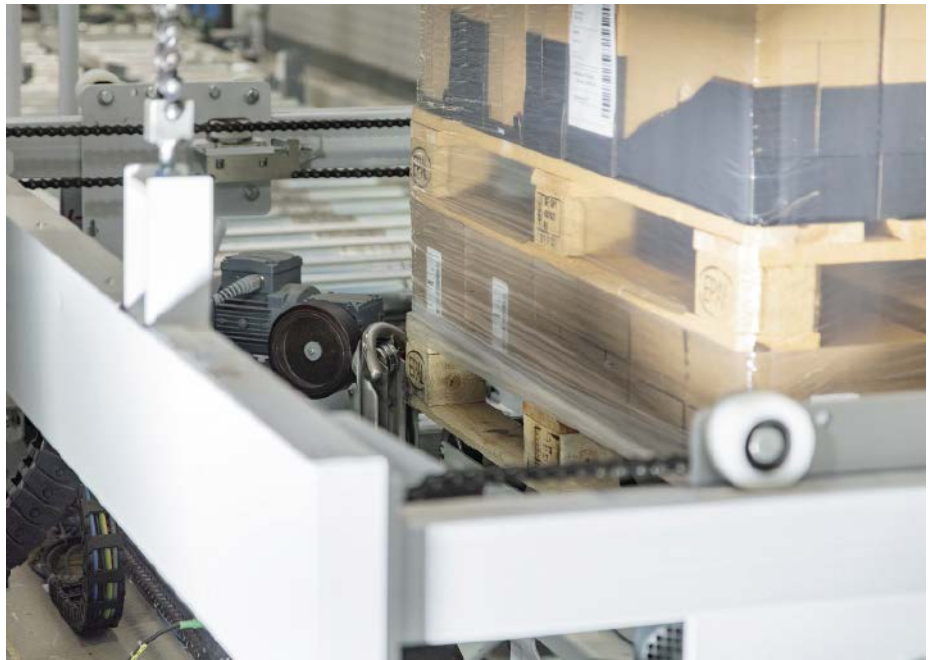
Abb. 3: Die Paletten werden in einer schnellen Taktung verpackt. Dabei überzieht die Maschine die Produkte mit einer hochdehnbaren Stretchhaube. Der Palettenfuß bleibt frei, damit die Kufen des Gabelstaplers die Folie nicht beschädigt.
