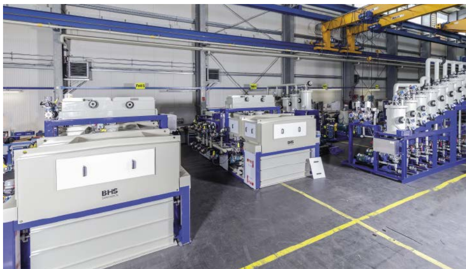
Abb. 2: Die gelieferte Anlage besteht aus zwei Taktbandfiltern sowie Mess- und Regeltechnik.
