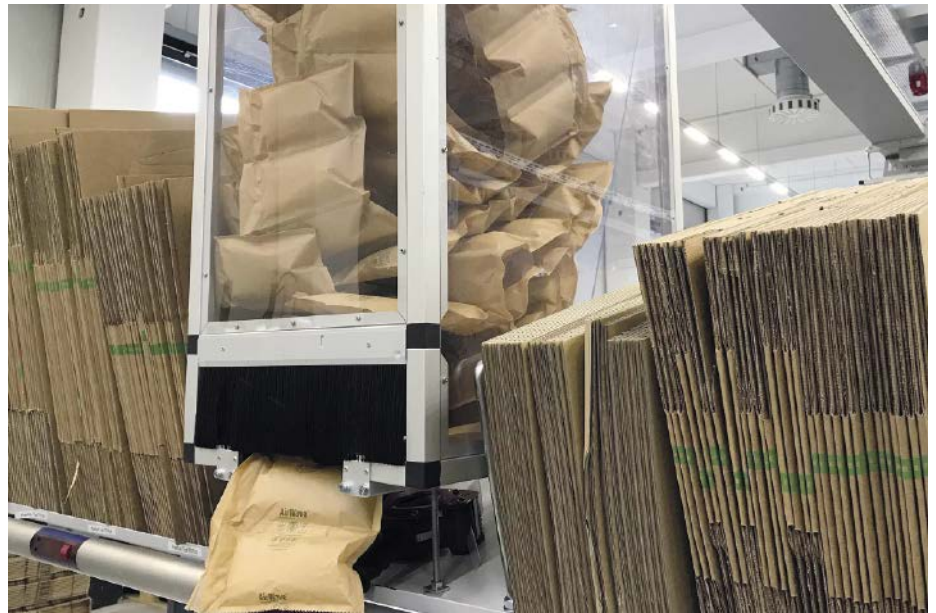
Abb.1: Die Papierluftpolster werden automatisch an den Pick-Platz geblasen.
