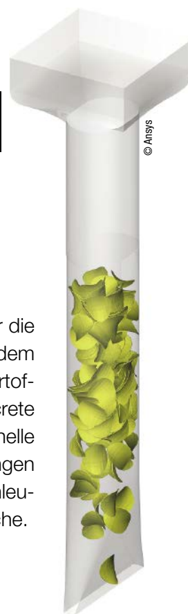
Abb. 2: Optimierung der Schüttgutmechanik bei Kartoffelchipsstüten mit Ansys Rocky.
