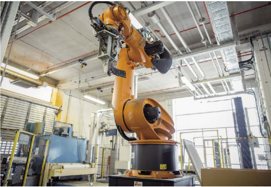
Abb. 2: Das Handling der Fässer auf Paletten übernimmt ein Roboter.
