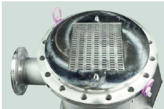
Geöffneter Produktionsreaktor mit 154 rechteckigen Reaktionskanälen und statischen Mischeinlagen.
