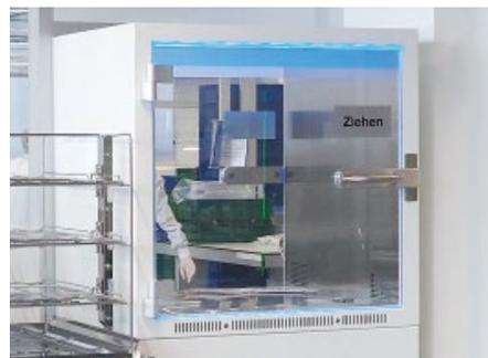
**Abb. 6: Wird die Schleuse gespült, leuchtet das Lichtband blau.**
