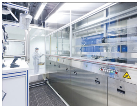
Abb. 2: Die End- bzw. Feinstreinigung medizinischer Produkte erfolgt üblicherweise in einer aufgabenspezifisch ausgelegten Reihentauchanlage, die in einen Reinraum integriert oder angeschlossen werden kann. © Ecoclean / UCM
