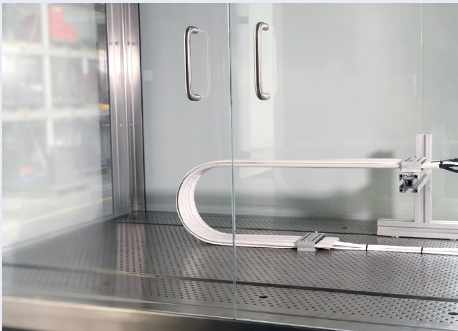
Abb.1: Die Tests zum Beispiel der e-skin Energieführungen finden gemäß der ISO 14644-14 Bedingungen in modularen Laminar Flow Boxen statt.
