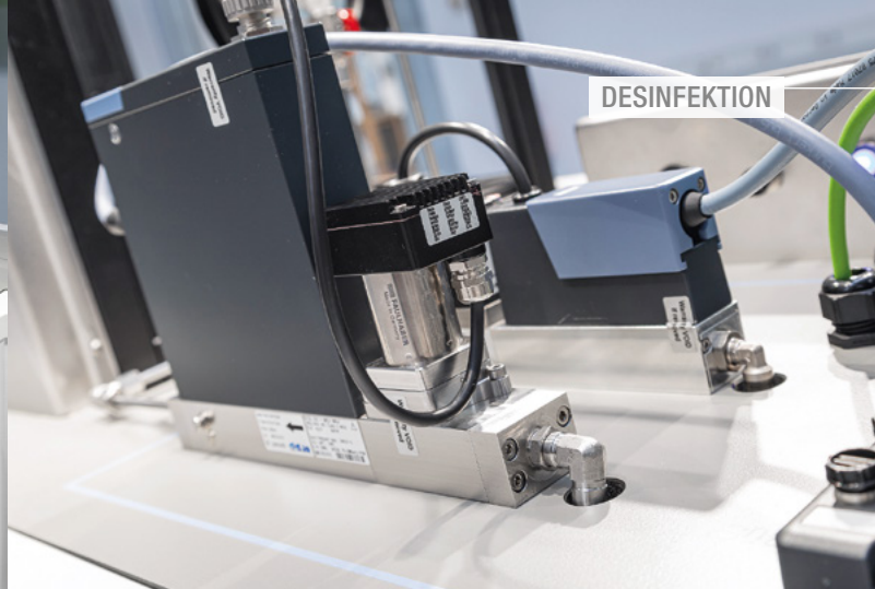
Abb. 2: Der Durchflussregler für Flüssigkeiten (LFC) regelt das Wasserstoffperoxid, die Zerstäuberluft kommt parallel dazu über einen Massendurchflussregler (MFC) präzise dosiert zur Düse.
