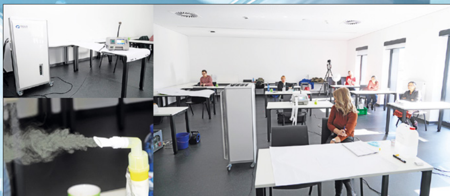
Abb. 1: Aufnahme des Seminarraumes (rechts) sowie des Equipments: Luftreiniger und Partikelzähler (links oben) sowie infizierte Person bzw. Vernebler (links unten)
