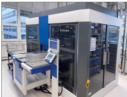
Abb. 1: Das umfassende Programm an Reinigungssystemen bietet Lösungen für alle Aufgaben entlang der Fertigungskette. Hier eine Anlage für die wässrige Zwischenreinigung bspw. vor einer Beschichtung.
