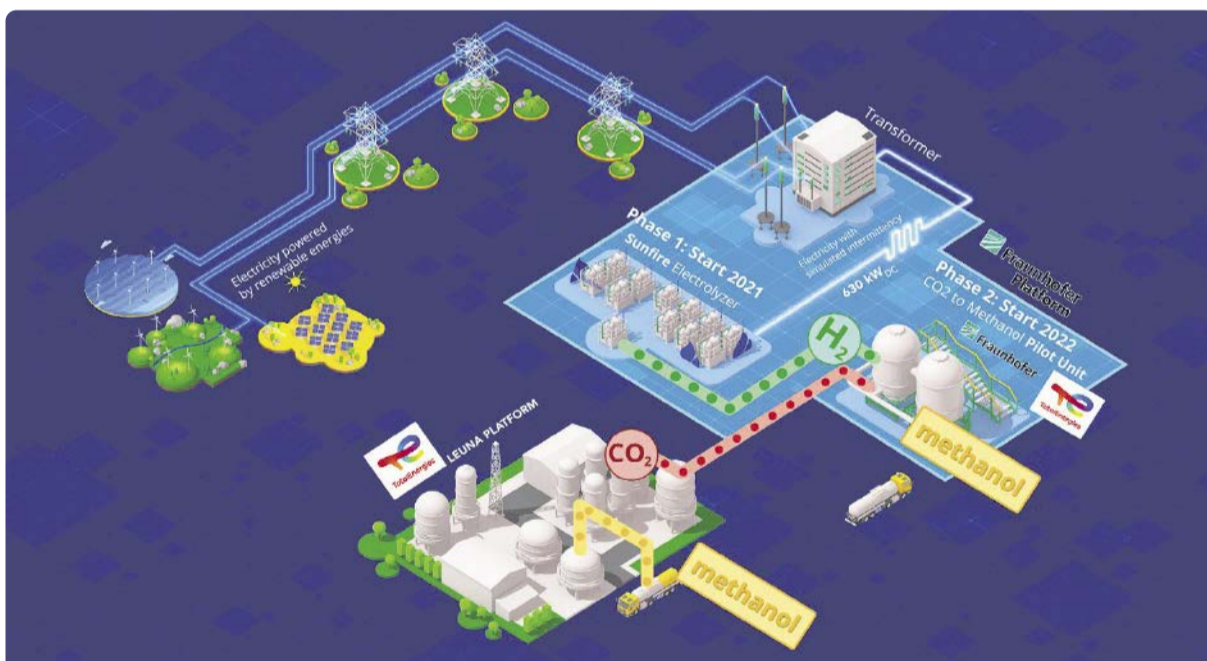
Schematische Darstellung der geplanten Anlage zur Herstellung von grünem Methanol in Leuna.
