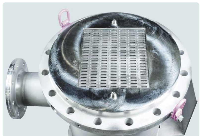
Geöffneter Miprowa Produktionsreaktor mit 154 rechteckigen Reaktionskanälen und statischen Mischeinlagen.
