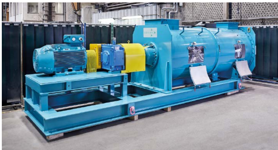
Abb. 2: Für eine gute Durchmischung rotieren in einer horizontalen, zylindrischen Trommel wandnah Pflugschar-Schaufeln.
