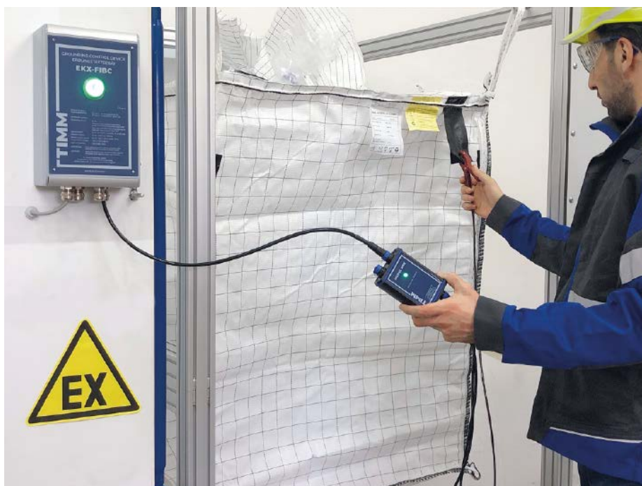
Abb. 1: Eine Überwachung der Erdung von Big Bags vermeidet Funkenbildung und steigert die Sicherheit in der Anlage.
