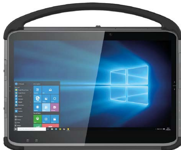
Abb. 3: Tablets wie das abgebildete DT313Y vereinen Eigenschaften robuster, industrietauglicher Geräte mit denen moderner Tablets aus dem Consumer-Bereich.
