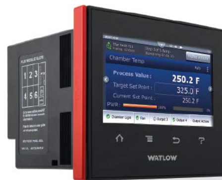
Abb. 2: Der Controller wird über das 4,3 Zoll große Touch-Display bedient. Am unteren Rand befinden sich statt empfindlicher Tasten vier beleuchtete Softkeys.
