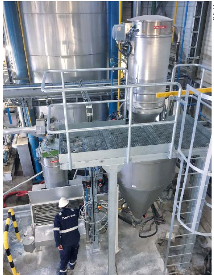
Das pneumatische Fördersystem minimiert das Materialhandling durch den Bediener.
