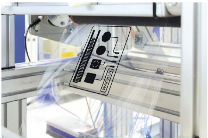
Elektroaktives Siliconlaminat eignet sich bspw. zum Bau von Sensoren, die Arm- und Beinbewegungen, Schrittfolgen und andere Bewegungen messen können.
