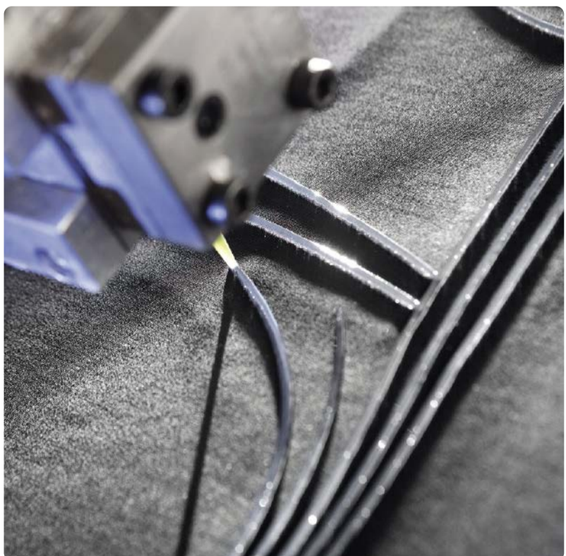
Polyamidverstärktes Silicon erhöht den Tragekomfort von Sporttextilien. Auch Sensoren lassen sich mit Silicon integrieren.
