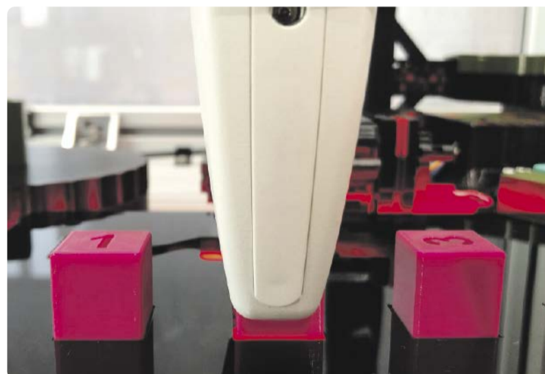
Mittels eines Vision-Sensors werden die Objekte anhand der Innen- und Außenkontur eindeutig identifiziert und entsprechend der Vorgaben am definierten Ablageort platziert.
