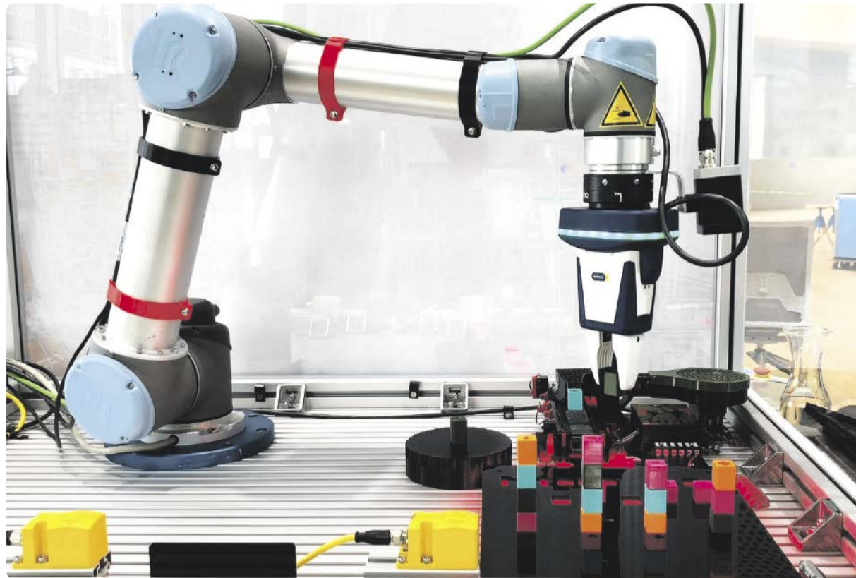
Über integrierte Suchalgorithmen lassen sich Aufgaben wie sortieren und kraftgeregeltes Stapeln robust und vereinfacht mit ArtiMinds RPS programmieren.
