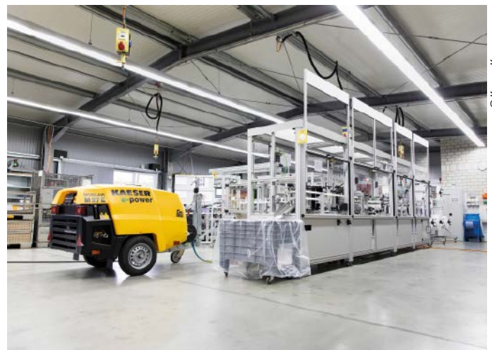
Abb. 1: Mobile Baukompressoren mit Elektroantrieb können auch innerhalb von Gebäuden aufgestellt werden, wie es bei Unimatic der Fall war.
