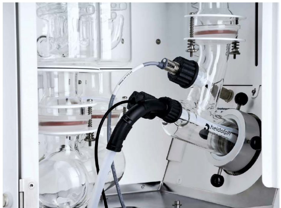
Abb. 3: Zum sicheren Dauerbetrieb ohne Aufsicht verfügt das Automatikmodul Hei-Volume Distimatic Pro über einen Notausensor am Verdampfer. ▶
