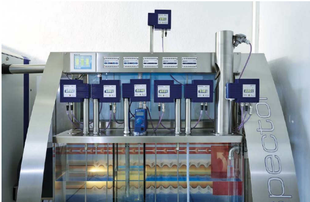
Abb. 4: Bei der Kesselausrüstung Spectroconnect vereinen sich unter anderem Universalbegrenzer, Niedrigwasser-, Hochwasser- und Leitfähigkeitselektroden mit Temperaturtransmittern und kapazitiven Niveausonden. Alle Komponenten werden tiefgehenden Funktionstests im hauseigenen Prüfaufbau unterzogen
