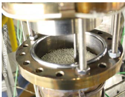
Abb. 2: Vorversuch für elektrothermische Speicher: Ein Speicher mit Schüttgut und Flüssigmetall als Wärmeträgerfluid
