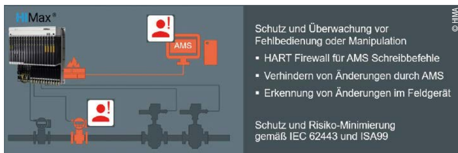
Abb. 2: Die integrierte SIL 3 Firewall schützt vor Fehlbedienung und Manipulationen.
