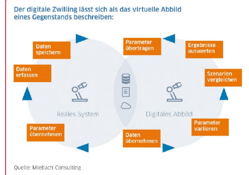
Grafik 1: Der digitale Zwilling kann als virtuelles Abbild eingesetzt werden, um Auswirkungen von Veränderungen am physischen Objekt im Sinne von Wenn-Dann-Analysen zu simulieren.
