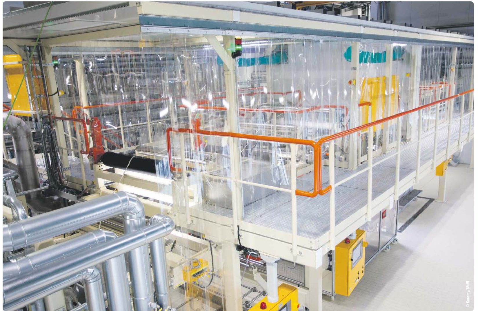
Echtzeitsensorik für Hightech-Folienproduktion: Am Standort in Troisdorf stellt Kuraray hochwertige PVB-Folien her, die als Zwischenlagen in anspruchsvollen Sicherheitsverglasungen in Architektur und Automotive zum Einsatz kommen. Gemeinsam mit den Forschern des Fraunhofer-Instituts testet Kuraray, wie neue 5G-Sensorik zu einer höheren Qualität sowie weniger Abfällen, Emissionen und Energieverbrauch beitragen kann.
