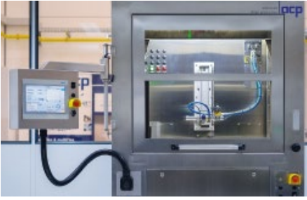
Abb. 1: Das zu reinigende Werkstück wird bei der komplett aus Edelstahl gefertigten Standalone-Anlage für die automatisierte Reinigung auf der Teileaufnahme eines x-/y-Achssystem, Drehtischs oder einer Kombination aus beidem in der Prozesskammer platziert.
