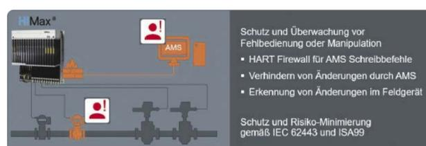
Mit HART-Informationen können die Einstellungen von Feldgeräten überwacht werden. Unerwünschte Parameteränderungen per Handheld-Gerät werden erkannt und alarmiert. Die integrierte SIL 3-Firewall schützt vor Fehlbedienung und Manipulationen.
