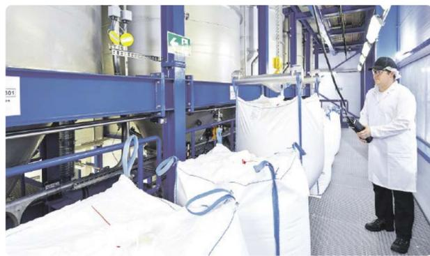
Abfüllungs- und Verpackungsanlage für Ionenaustauscher in einer Leverkusener Anlage.
