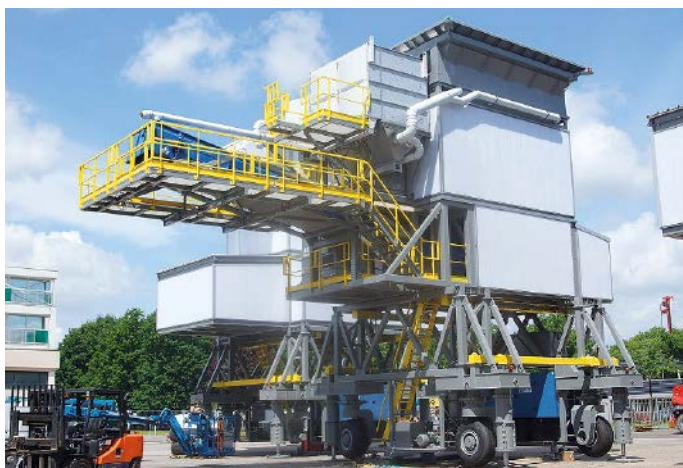
Abb. 1: Mobile Waagen: Meyland baut jeden Trichter zunächst in Belgien auf, testet diesen und versendet ihn dann erst in das jeweilige Bestimmungsland.
