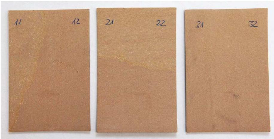
**Abb. 2: Optische Überprüfung novapress 850 nach 14 Tagen Einlagerung in R32 mit Kompressoröl BSE 32 bei 14 bar Druck: Das Material hält den Bedingungen vollkommen unbeschädigt stand.**
