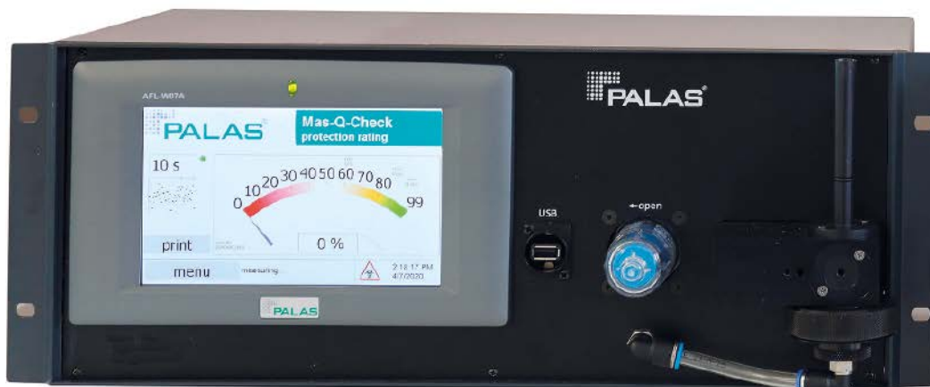
Abb. 4 Schnelltest für die Wirksamkeit von Gesichtsmasken
