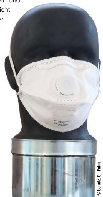
Abb. 4 Schnelltest für die Wirksamkeit von Gesichtsmasken
