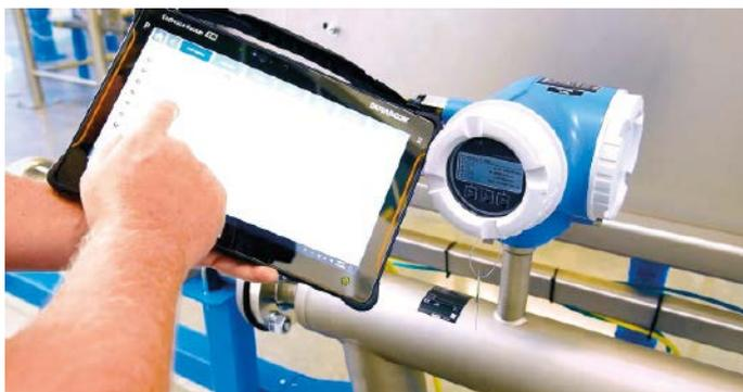
Abb. 2: Die Industrietablets Field Xpert sind als Ex- und Nicht-Ex-Version verfügbar.
