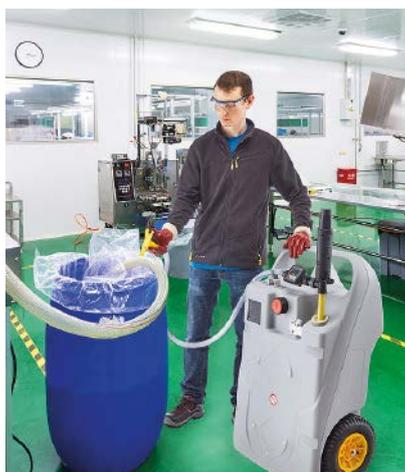
**Mobile Abfüllstation zur Chemikalien-Betankung**
