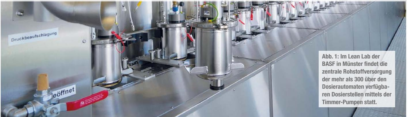
Abb. 1: Im Lean Lab der BASF in Münster findet die zentrale Rohstoffversorgung der mehr als 300 über den Dosierautomaten verfügbaren Dosierstellen mittels der Timmer-Pumpen statt.
