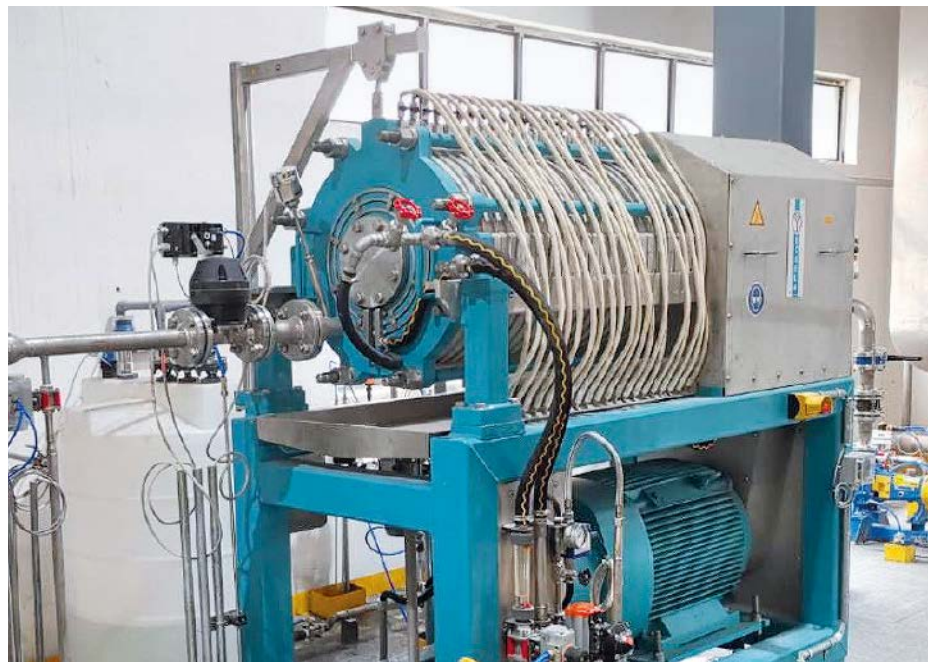
Abb. 3: BoCross Dynamic Filter L8 mit 8 m 2 Filterfläche zur Filtration von Kalziumkarbonat.
