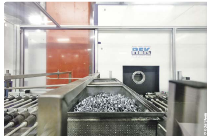
Einzelteile für die Schrittmotoren nach dem Entfettungsprozess
