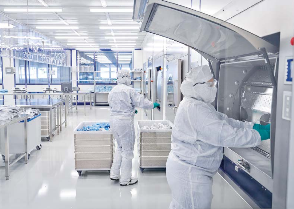
Abb. 2: Das Hygienekonzept RABC nach EN 14065 garantiert beim desinifizierenden Waschverfahren die Einhaltung gleichbleibend hoher Standards, sowie die systematische Kontrolle der mikrobiologischen Qualität.
