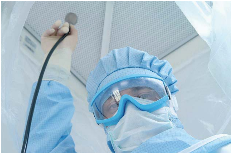
Abb. 3: Filterlecktest im Reinraum SMB
