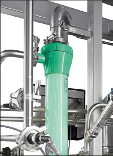
Abb. 1: Kaltmembranverfahren (hier eine Pharmatec MWFI-Anlage von Syntegon) sind im Vergleich zur Destillation wirtschaftlich und ökologisch effizienter.
