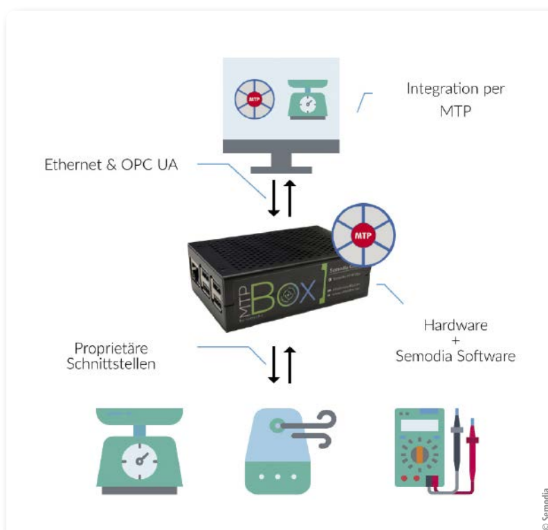
Die MTP-Box erlaubt es, Bestandsequipment (z.B. Ventile, Pumpen, Labortechnik o.ä.) von Labor- und Technikanlagen über den Modular Type Package (MTP)-Ansatz modular aufzubauen und zu steuern.
