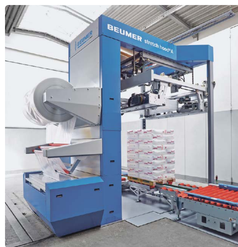
Ein Folientransportsystem führt der Anlage Beumer stretch hood A die zuvor zugeschnittene und verschweißte Folienhaube zu.
