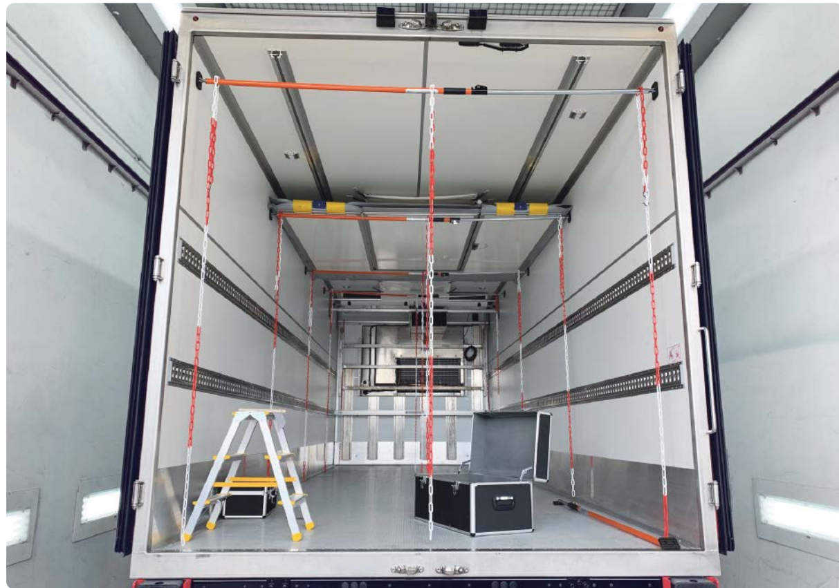
Ein Lkw steht bereit in der EIPL-Kältekammer zur Durchführung eines Temperatur-Mappings.
