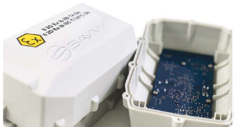
Anqore hat auf jedem seiner Kesselwagen und Tankcontainer ein ATEX- und IECEX-zertifiziertes „SAVVY CargoTrac ExR“-Telematikgerät installiert.
