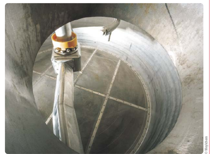
Beheizbarer Filtertrockner mit Rührer am Standort Frankfurt-Fechenheim.
