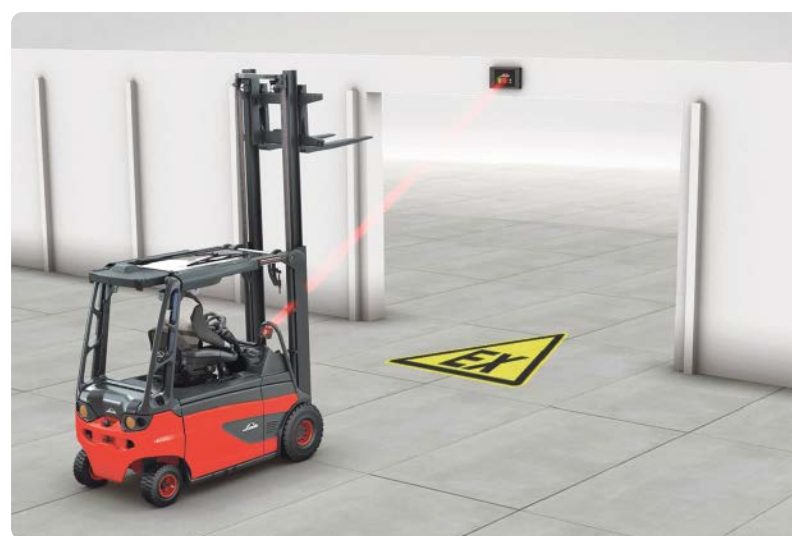
Durch die Kopplung des Linde Safety Guard mit einem stationären Warnprojektor, der ein Ex-Symbol auf den Boden projiziert, werden die Fahrer von Standardfahrzeugen aktiv vor der Einfahrt in den ATEX-Bereich gewarnt.
