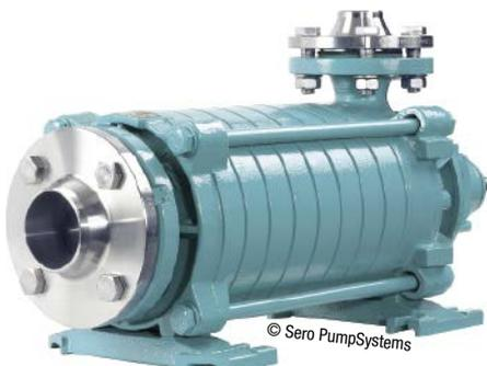
**Abb. 2:** Die Flüssiggaspumpe NHE-LPG ist für Fördermengen bis 170 m<sup>3</sup>/h bei einer maximalen Förderhöhe von 290 m spezifiziert.
