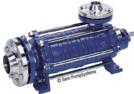
**Abb. 1:** Die Seitenkanalpumpe SRZS-LPG für den Transport von LPG-Flüssiggas ist auf Förderleistungen bis 35 m<sup>3</sup>/h ausgelegt – dank einer Saughöhe von vier Metern auch aus unterirdischen Tanks.
