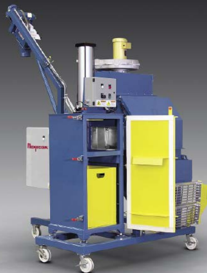
Abb. 2: Staub, der bei der Sackentleerung, der Durchgabe der leeren Säcke und der Sackverdichtung entsteht, wird auf mit Luftdüsen ausgestatteten Patronenfilter gesaugt, die die Staubansammlung in einem zeitgesteuerten Zyklus ablösen.
