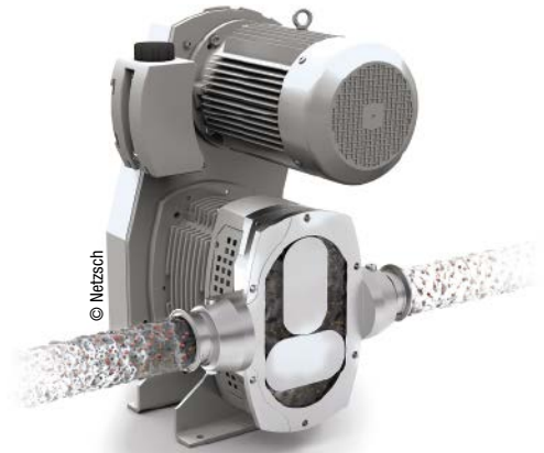
Abb. 2: Die Funktion der Pumpe basiert auf zwei Drehkolben, die gegenläufig rotieren und so das Medium von der Saug- zur Druckseite transportieren. Da hierbei rein nach dem Verdrängerprinzip gefördert wird, sind Druckschwankungen oder Scherkräfte ausgeschlossen.
