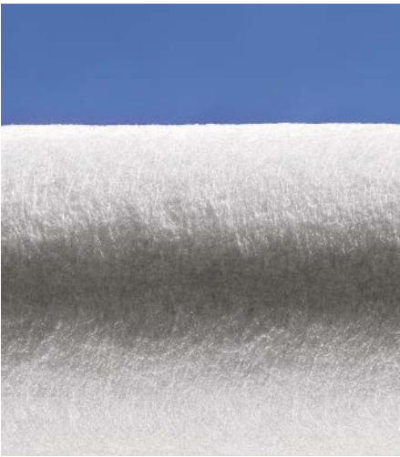
Abb. 2: Die 3-D-Filterstruktur der AS-Tiefenfilterkerzen erhöht die Schmutzaufnahmekapazität um das 3- bis 5-fache gegenüber herkömmlich aufgebauten Tiefenfilterkerzen zur Klassifikation.
