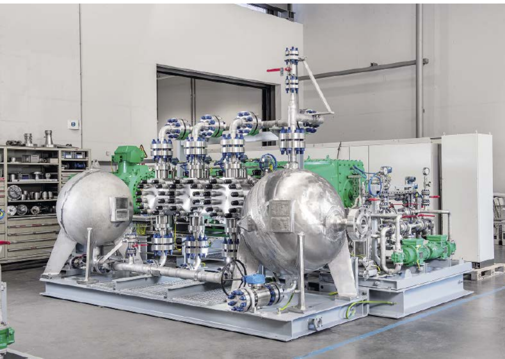
Abb. 2: Bei überkritischen Anwendungen wie der Herstellung von Weichmachern ist eine hermetisch dichte Prozessmembrantechnologie erforderlich.
