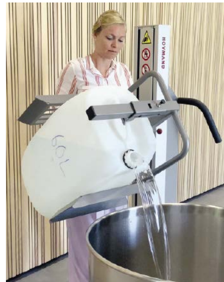
Abb. 1: Mit der mobilen Abfüllhilfe für Kanister können schwere Kanister ergonomisch angehoben und gezielt entleert werden.
