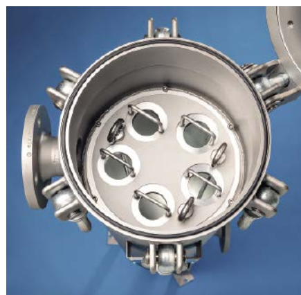
Abb.7: Die WTHKE-Gehäuse mit hängenden Kerzen eignen sich am besten zur Filtration von Slurry. Durch die Stutzenstellung SU (seitlich unten) erfolgt der Durchfluss vertikal von unten nach oben.
