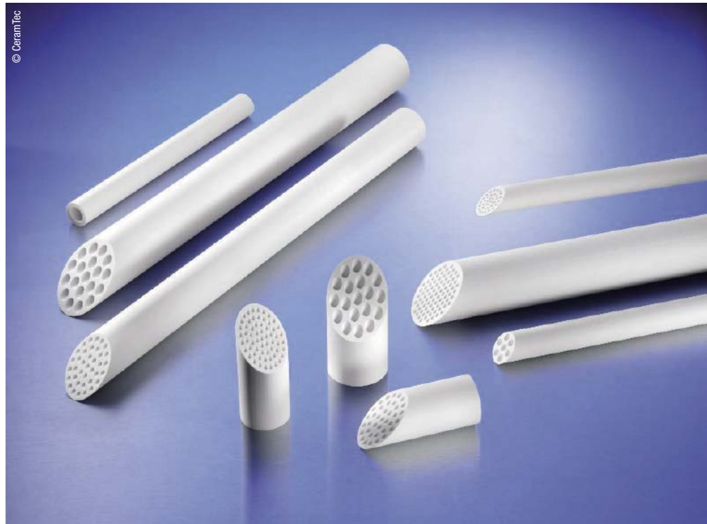
Poröse Keramik-Membranrohre von CeramTec werden bei der Querstromfiltration eingesetzt. Die porösen Tragrohre bieten die maximale Leistung, welche die Technologie derzeit ermöglicht, sowohl hinsichtlich der Anzahl der Kanäle als auch bei der Rohrlänge.
