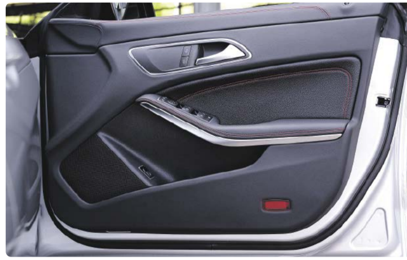
Ein Beispiel für die Nutzung thermoplastischer Verbundwerkstoffe ist die Reduktion des Gewichts der Innenteile einer Autotür.
