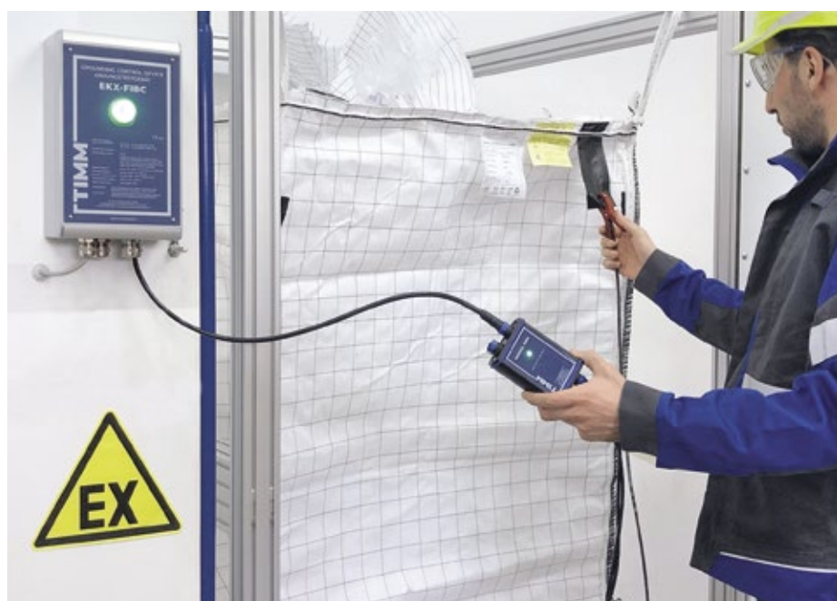
Abb. 2: Big Bag-Erdung mit TIMM EKK-FIBC
