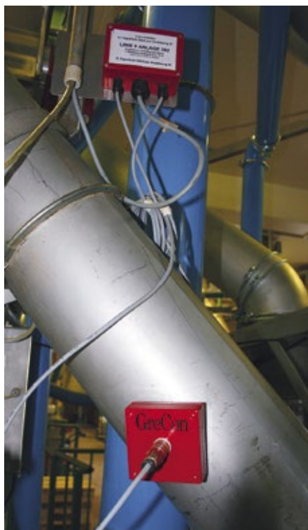
Abb. 2: Bei dem Teehersteller kommen durchweg GreCon-Funkenmelder des Typs „FM 1/8“ zum Einsatz. Diese hocheinsensiblen Melder sind speziell dafür konzipiert, in Förderleitungen oder Fallschächten mit hoher Materialbelastung eingesetzt zu werden.
