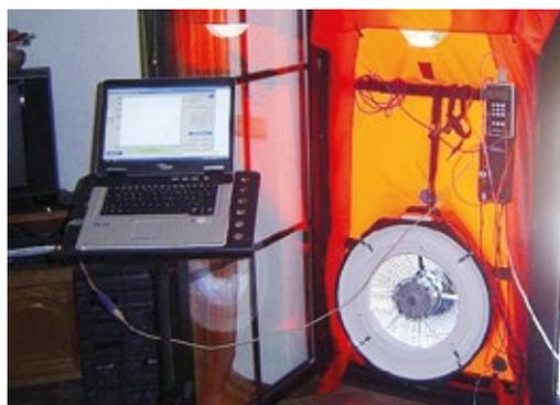
Abb. 2: Blower-Door-Test (Foto: Bauthermografie & Luftdichtheitsprüfung Lutz Weidner/Thüringen. Anobimpunctatum at de.wikipedia / CC BY-SA 3.0)
