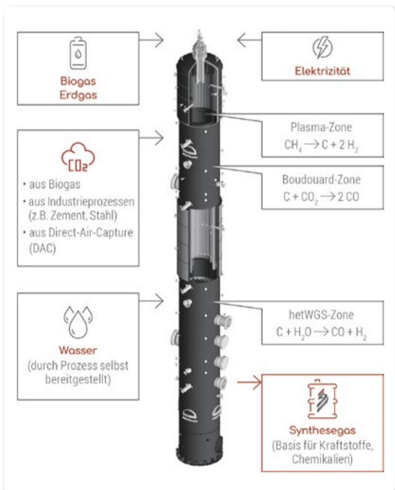
Der von Caphenia entwickelte Prozess zur Herstellung von Synthesegas aus Biogas, Kohlendioxid, Wasser und Strom läuft in einem einzigen so genannten Zonenreaktor ab.
