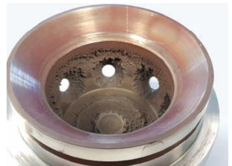
Abb. 2: Durch Kavitation beschädigte Drosseln, wie hier im Bild, gehören dank des SIP der Vergangenheit an.
