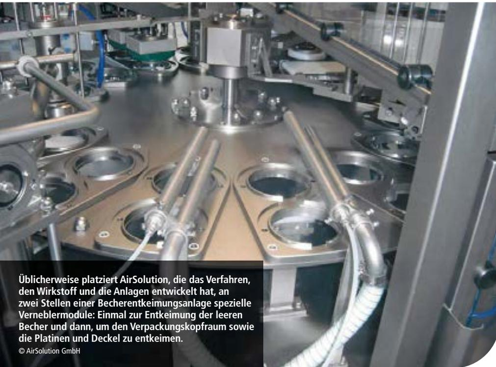
Üblicherweise platziert AirSolution, die das Verfahren, den Wirkstoff und die Anlagen entwickelt hat, an zwei Stellen einer Becherentkeimungsanlage spezielle Verneblermodule: Einmal zur Entkeimung der leeren Becher und dann, um den Verpackungskopfraum sowie die Platinen und Deckel zu entkeimen.
