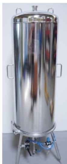
alternativ mit USP-Class VI und BSE-Freiheitsbescheinigung, eingesetzt. Der Betriebsdruck wird mit -1/+10 bar bei einer Temperatur bis max. 140 °C angegeben. Oberflächen können bis  $Ra \leq 0,4 \mu m$  und elektroliert gefertigt werden. Diese neue Generation von Modulfiltergehäusen ist in vier unterschiedlichen Höhen erhältlich.
