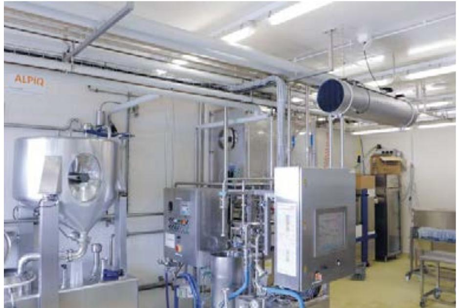
Abb. 1: Um das Wachstum unerwünschter Schimmel- und Hefepilze sowie von Bakteriophagen zu verhindern, entschied sich das Unternehmen nach ausgiebigen Beratungen dazu, UVC-Entkeimungsgeräte von sterilAir zu installieren. Dazu zählen unter anderem ein Umluftentkeimer mit besonders hoher UVC-Strahlen-Dosis.
