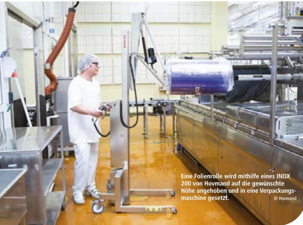
Eine Folienrolle wird mithilfe eines INOX 200 von Hovmand auf die gewünschte Höhe angehoben und in eine Verpackungsmaschine gesetzt. © Hovmand
