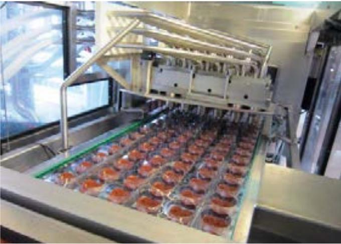
Abb. 1: Um die Bedingungen bei der Puddingabfüllung im Werk von Danone in Ochsenfurt zu verbessern, wird an den neuralgischen Punkten im Pudding-Abfüllprozess ein gesundheitlich unbedenklicher, mikrofeiner Wirkstoffnebel eingebracht, der die Zahl der Keime in der Umgebungsluft und auf den Oberflächen messbar reduziert. © Danone GmbH
