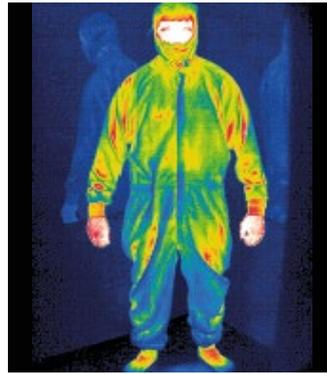
Abb. 2: Wärmeentwicklung unter der Reinraumbekleidung © dastex
