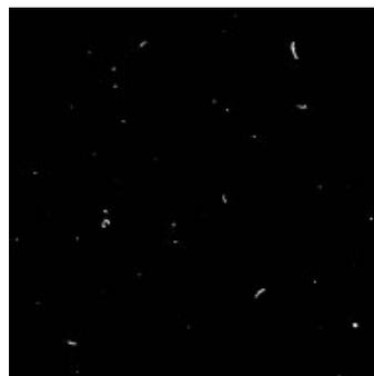
Abb. 19: C&C-Indikatorplatte nach Abdruck von Polyester-Zellstoff-Tuch
