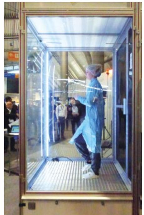
Abb. 4: Die Bodybox-Prüfmethode, die an der Aktionsbühne von Dastex präsentiert und erläutert wurde
