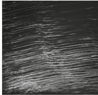
Abb. 26: Abwischen eines Fingerabdrucks mit nicht dekontaminiertem Reinigungstuch Maschendichte 400 = deutliche Schlieren.
