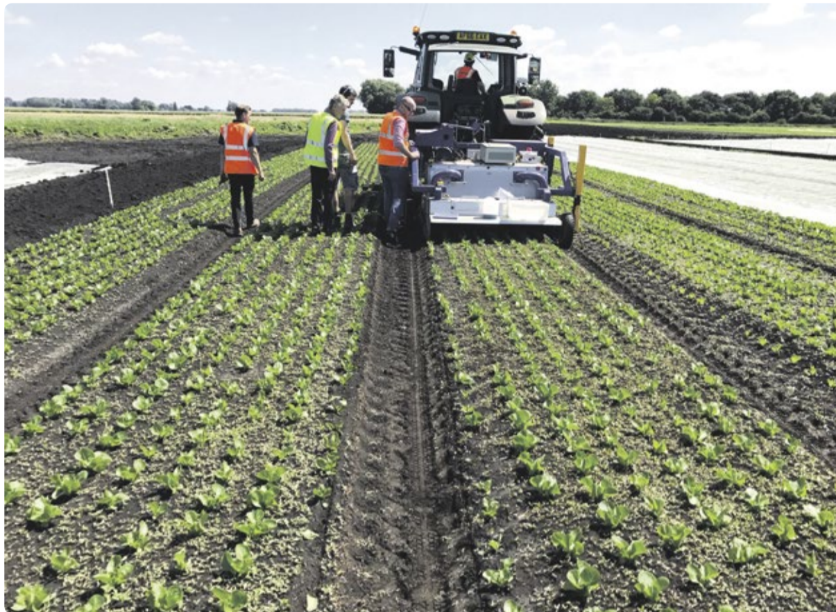
Mit der „Hyperweeding“-Technologie werden sensorgestützte Anwendungen für Spritzgeräte entwickelt, mit denen Unkräuter identifiziert werden können. Dies ermöglicht eine extrem exakte Ausbringung von Pflanzenschutzmitteln nur auf die Unkräuter.
