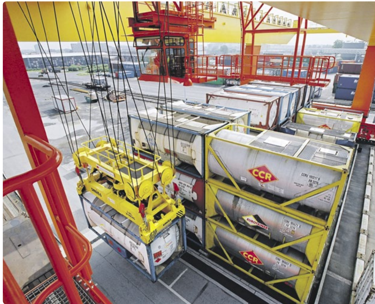
Im Industriepark Höchst ermöglichen zwei große Portalkräne den Containerumschlag.
