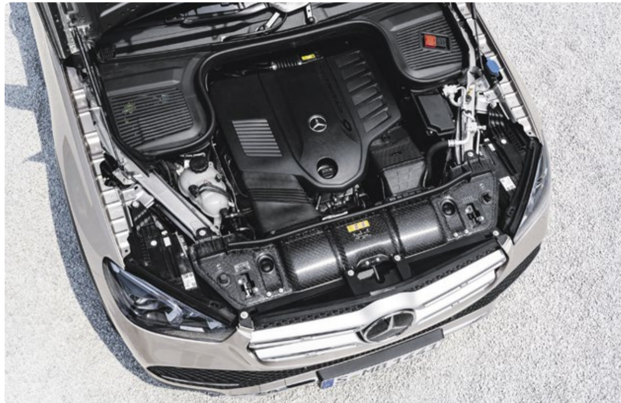
Der Frontend-Träger im Mercedes-Benz GLE besteht aus zwei verschweißten Tepez-Verbundhalbschalen. Die verstärkenden Glasfaser-Rovings verleihen dem Bauteil einen sportlichen Look mit carbon-ähnlicher Anmutung.
