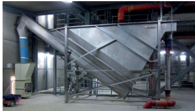
Abb. 2.: Grobteile von ca. 0,1 bis 5 mm werden im Feststoffabscheider separiert.
