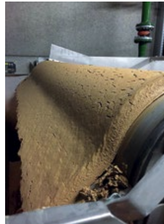
Abb. 3: Der Filterkuchen als „Teppich“ von 5-9 cm Stärke im Vakuumbandfilter
