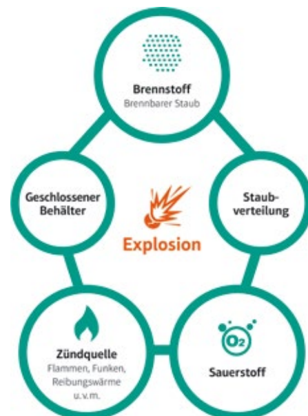
Abb. 2: Die fünf Voraussetzungen für eine Staubexplosion
