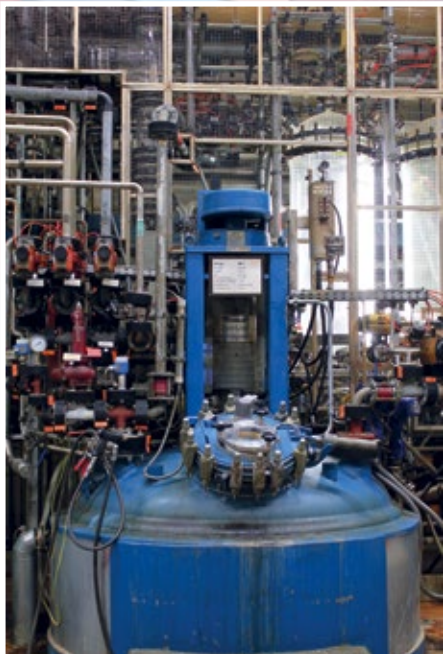
Abb. 3: CHT fertigt Spezialchemikalien unter anderem in vollautomatisierten Batchreaktoren.
