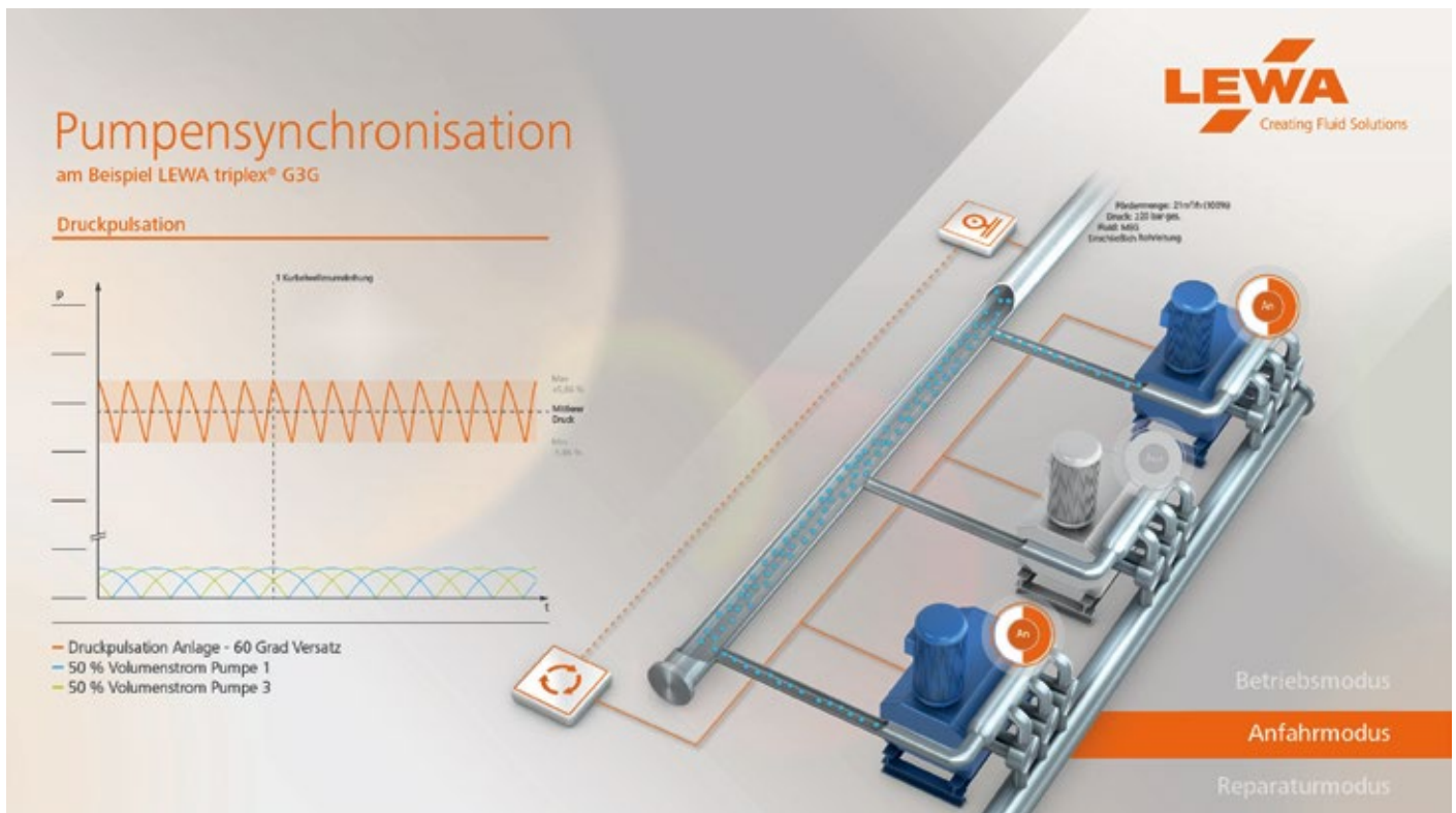
Abb. 1: Um die Pulsation des geförderten Fluids zu reduzieren beziehungsweise Vibrationen in den Leitungen zu unterbinden, bietet sich eine Synchronisation mehrerer Pumpen an. Um dabei genaue Aussagen zu dynamischen Vorgängen oder Druckamplituden machen und das Gesamtsystem entsprechend auslegen zu können, hat Lewa kürzlich ein leistungsstarkes eindimensionales CFD-Softwaremodul entwickelt.
