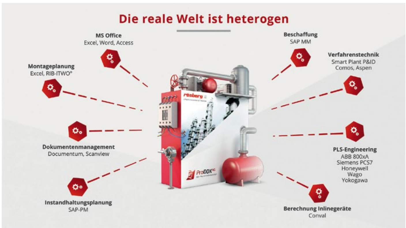
Abb. 1: „Adapter“ konvertieren die Daten, die andere an der Anlagenplanung beteiligten Softwaretools liefern und übergeben sie an ProDOK.
