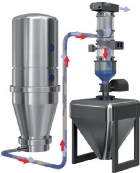
Abb. 1: Beispielhaftes Fliebschema einer Vakuumförderanlage: Produktaufgabe, Förderleitung, Vakuumförderer und Produktabgabe (Beschickung)
