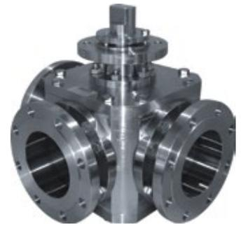
Markt erhältlichen metallischen Kugelhähnen, denn diese haben lediglich „Leckrate B“, die einen gewissen Grad an Blasen pro Minute erlaubt. Die metallisch gedichteten 3-Wege-Kugelhähne zeichnen sich durch eine verlängerte Standzeit, verlängerte Schalthäufigkeit, hohe Strömungsgeschwindigkeiten und hohe chemische Beständigkeit gegen Korrosion und eine dementsprechende Reduzierung der Wartungsintervalle aus.
