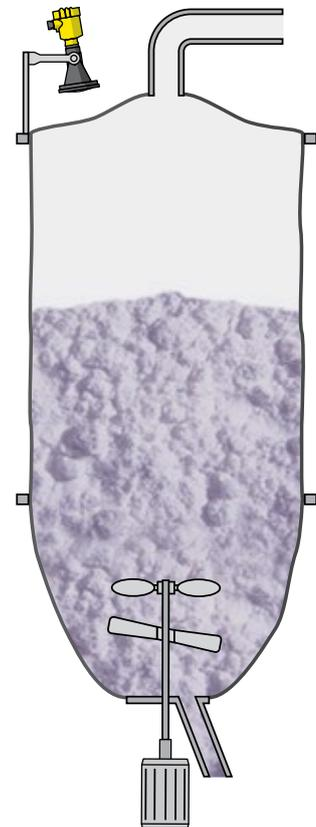
Abb. 4: Füllstandmessung von Dämmmaterialver-schnitt in einem Sacksilo mit Rührwerk.
