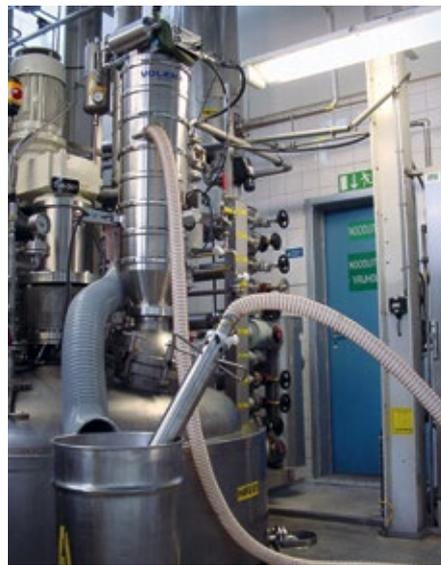
Abb. 2: Absaugung und Förderung von Pulvern aus Fässern mittels Sauglanze (vorn) und Zuführung in einen Misch- und Rührkessel mittels Vakuumförderer (im Hintergrund, auf Mannloch montiert)
