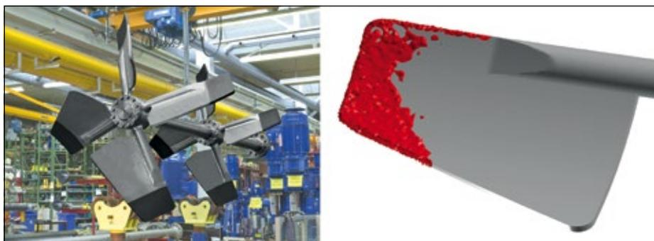
Abb. 5: Mit Metalloxid beschichtetes EPAL-Rührorgan und Simulation der Wirbelstärke an der Blattspitze.
