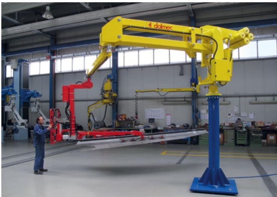
Abb. 1: Der neue Manipulator ist in der Lage, Lasten bis zu 1.500 kg zu handhaben und Radien von bis zu 5.000 mm mit Gewichten von 650 kg zu erreichen.
