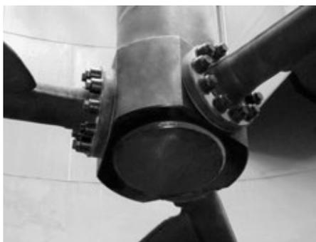
Abb. 4: Gummiertes Rührorgan mit Nabenanbindung an die Welle, kombinierter Verschleiß- und Korrosionsschutz
