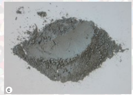
Abb. 1 a–c: Lösungen zum Urban Mining bietet etwa Retsch an: Die Platinen (a) werden mit einer Schneidmühle SM 300 vorzerkleinert (b) und im Anschluss mit der Ultra-Zentrifugalmühle ZM 200 pulverisiert (c).
