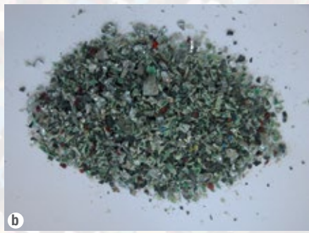
Abb. 1 a–c: Lösungen zum Urban Mining bietet etwa Retsch an: Die Platinen (a) werden mit einer Schneidmühle SM 300 vorzerkleinert (b) und im Anschluss mit der Ultra-Zentrifugalmühle ZM 200 pulverisiert (c).
