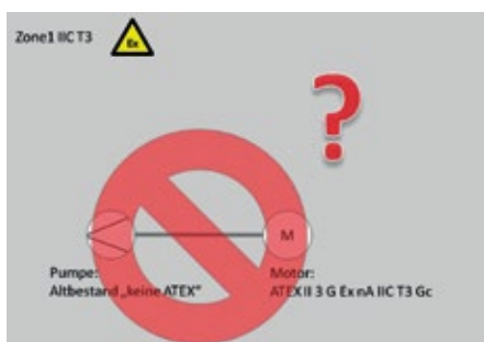
Abb. 1: Weder Pumpe noch Motor haben eine Zulassung für die Explosionsschutzzone 1. Was tun?
