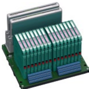
Abb.: Das Yokogawa-System erkennt die Art des angeschlossenen eigensicheren Interfacemoduls und konfiguriert das System automatisch.
