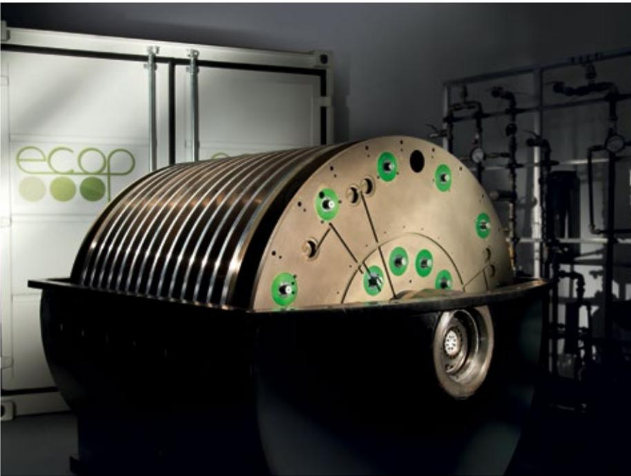
Abb.3: Ecop Hochtemperaturwärmepumpe für bis zu 150 °C.
