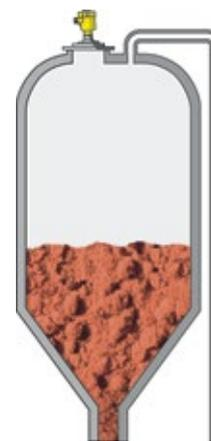
Abb. 3: Messung von Farbpigmenten mit pneumatischer Förderung – Der Vegapuls 69 ermöglicht auch bei extremer Staubeentwicklung eine zuverlässige Erfassung des Siloinhalts.
