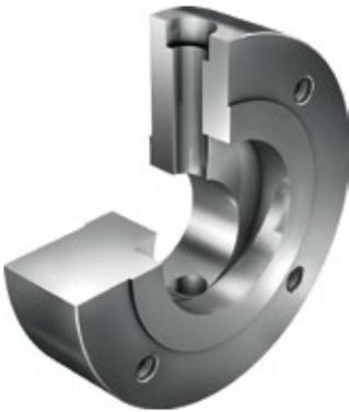
**Abb. 1:** Der Entleerungs- und Spülring von AS-Schneider erlaubt ein kontrolliertes Entleeren des Hohlraums zwischen der Erstabspernung und dem Messgerät.
