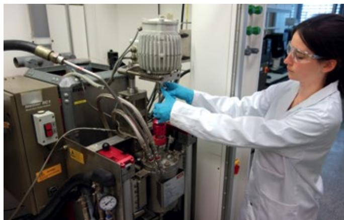
Reaktionskalorimeter RC-1 MP10 zur Untersuchung der thermischen Prozesssicherheit von chemischen Reaktionen unter Druck
