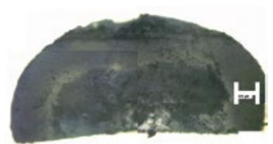
Abb. 1: Mit dem in situ Verfahren beschichtete Pastille sowie ein Schnittbild einer solchen Pastille.
