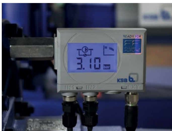
Abb. 4: Mit der digitalen Anzeige- und Auswerteeinheit PumpMeter hat das technische Betriebspersonal die Betriebsdaten der Pumpen im Blick sowie die Kontrolle, ob die Pumpen in einem optimalen Wirkungsgrad laufen.
