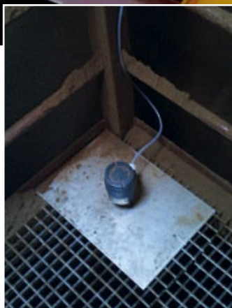
Abb. 2: Die Messgeräteserie PulsFox PMG 10 sind zur genauen Füllstandmessung von hoch- oder niederviskosen, anhaftenden, leitfähigen oder isolierenden Flüssigkeiten und Schüttgütern, z. B. in Lager- und Prozessbehältern, Silos oder Tanks, konzipiert. Im Bild ist ein Füllstandmessgerät PMG 10 MF zu sehen, das im Silo oben eingebaut ist.
