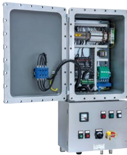
Abb. 2: Steuerung Ex de mit elektrischen Komponenten in geöffnetem Ex-d-Gehäuse und Bedienelementen im Ex-e-Anschlussgehäuse (MAC0003046)
