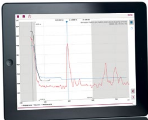
Abb. 2: FMR10 und FMR20 gehören zu den ersten berührungslosen Radargeräten mit Bluetooth Inbetriebnahme-, Betriebs- und Wartungs-App. Die Signalkurve kann mit der App auf jedem Bluetooth-fähigen Smartphone oder Tablet (iOS, Android) angezeigt werden. ▼
